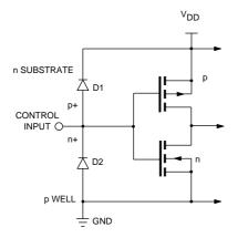
Fig. 2a Equivalent Input Circuit
